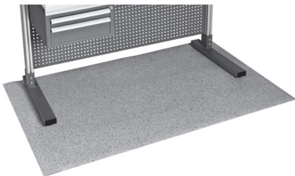
Antistatische Bodenmatte, Stärke 2,5 mm, abriebfest, schalldämmend, nicht entzündlich, thermische Stabilität, ableitende Oberseite und leitende Unterseite, Ableitgeschwindigkeit: von 1000V bis 50V in < 0,5 Sekunden, Widerstand zur Erdleitung < 100 MΩ, kombiniert < 35 MΩ. Verschiedene Abmessungen: 150 mm × 200 bis 1000 × 10000 mm.
