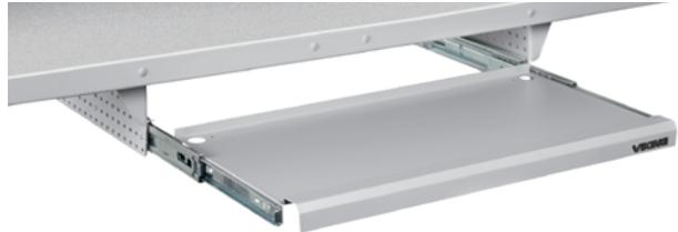
Die Tastaturplatte ist zum leichteren Gleiten mit einer Ausziehvorrichtung versehen. Das Plattenmaterial ist mit dunkelbrauner (RAL 7012) oder hellgrauer (RAL 7035) Pulverlack beschichteter Stahl. Die Platte ist für alle Tischtypen geeignet, sie kann an allen Arbeitsplätzen mit einem über 616 mm breiten und 383 tiefen Freiraum unter der Tischplatte montiert **werden**.
